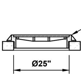
CAST IRON FRAMES AND COVERS ARE AVAILABLE IN SUBURBAN 3" HEIGHT AND STANDARD 7" HEIGHT (SUBURBAN 3" HEIGHT SHOWN)
